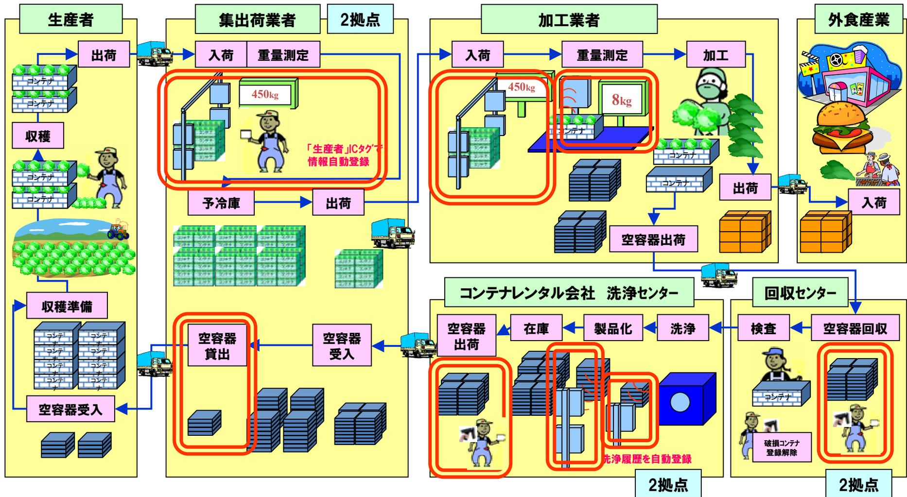
電子タグによる一括読取りで入出荷確認や洗浄履歴登録など大幅に業務効率化
