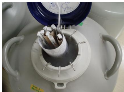
写真 3 液体窒素容器中のかご(キャニスター)にアルミケーン(アンプル支持棒)が入っているところ
