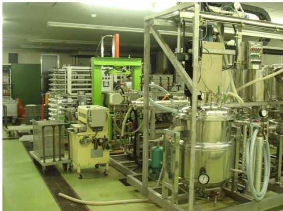
(社)長野県農村工業研究所の製品試作室に置かれている機器類(手前にあるのが、利用頻度の高い多目的真空調理装置である)
