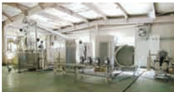
馬路村農協に設置したマイクロ波抽出装置(試作機)
