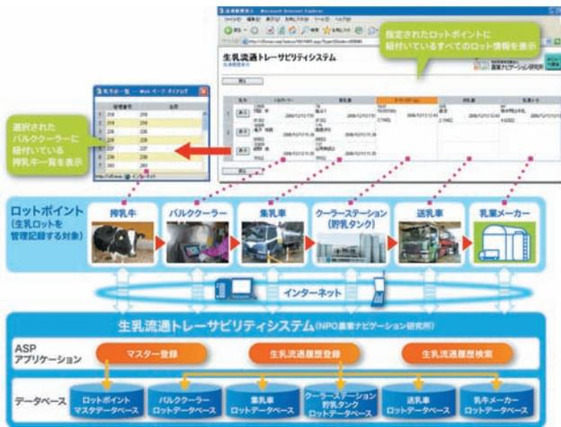
記録される受渡し情報は、受入先（川下）の情報として、①ロットポイントの種類（集乳車、クーラーステーション、送乳車、乳業メーカーなど）、②ロットポイント名（車体No.、タンクNo.など）③受入日時、④管理番号、⑤乳量を入力する（図7-1-6PC画面上部）。
