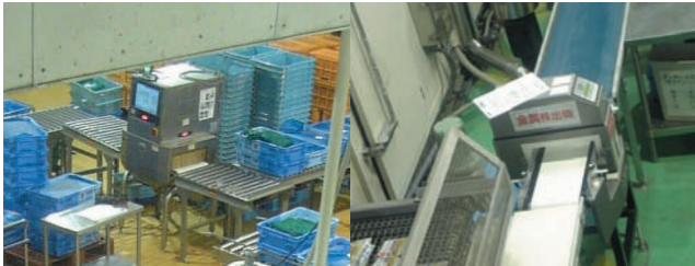
工場ライン内のX線検査機（左）と金属探知器（右）
